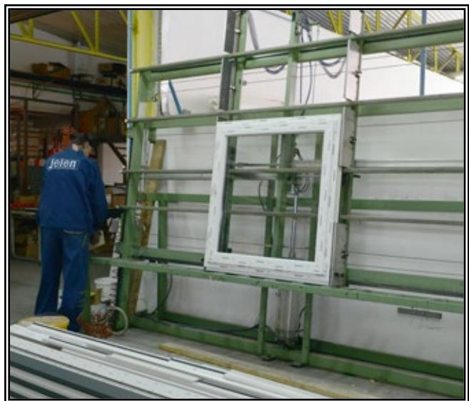
Zastakljivanje prozora na presi za optimalni položaj stakla u prozoru
