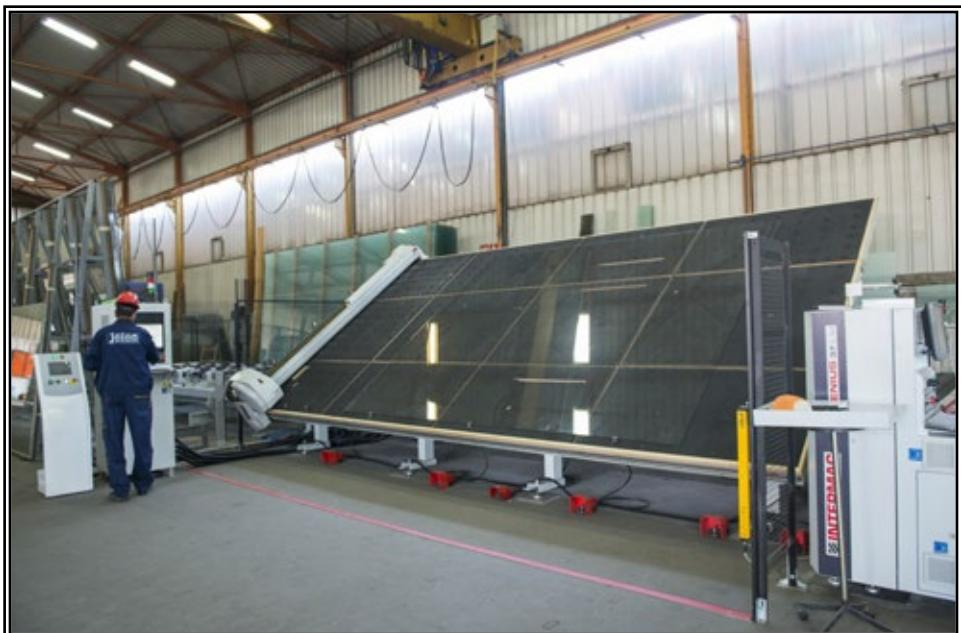
Automatski sto za sječenje monolitnog stakla
