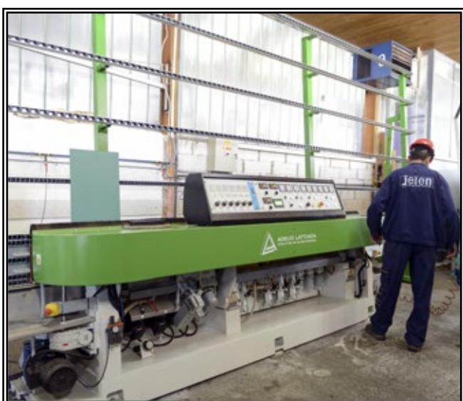
Brusilica i polirka za staklo debeline do 36 mm sa mogućnošću brušenja pod ugлом
