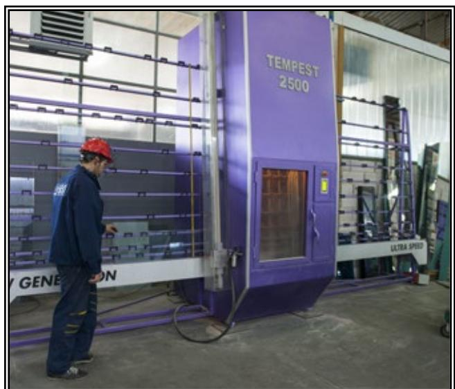
Automatska mašina za pjeskarenje stakla
