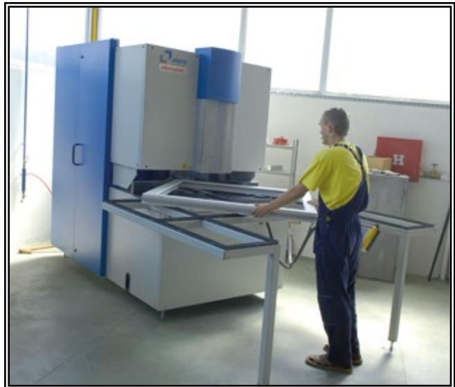
Automatska CNC čistilica za čišćenje varova na PVC profilima
