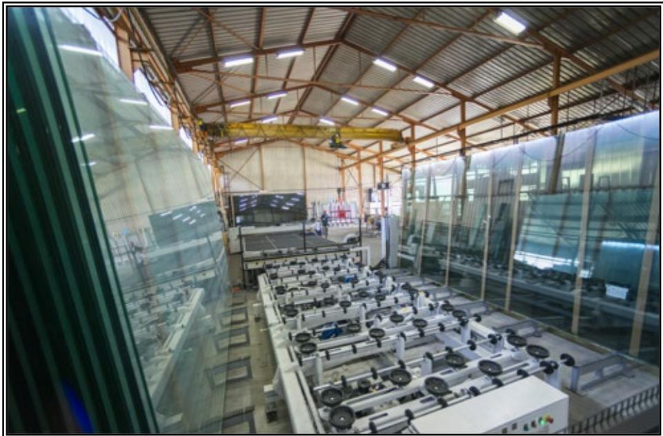
Automatska linija za sječenje monolitnog i laminiranog stakla JUMBO formata 6000x3210 mm, kapaciteta 1000 m<sup>2</sup> stakla u 1 smjeni
